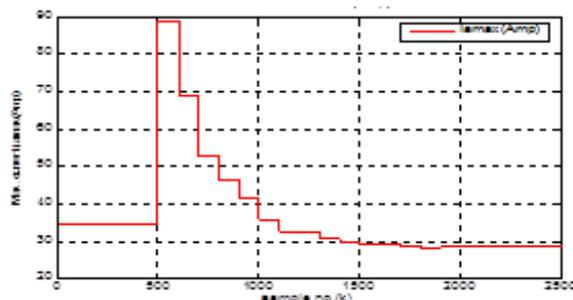
(d) The maximum value of total supply current per each cycle ( $i_{smax}$ ).
